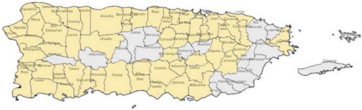
Figura 33 – Los municipios marcados en gris tenían 0% de energía eléctrica el 20 de noviembre de 2017 (Fuente: Castro-Sitiriche, M., Cintrón-Sotomayor, Y. & Gómez-Torres, J. (2018). "The Longest Power Blackout in History and Energy")
