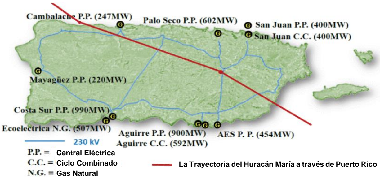
Figura 12 – Trayectoria del Huracán María en su paso por Puerto Rico y ubicación de las instalaciones de generación de energía (Fuente: Huracán María Effects on Puerto Rico Electric Power Infrastructure- IEEE)
